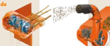
Sur les broyeurs Eliet 4S, les avantages du Principe de la Hache™ Eliet sont renforcés avec le système **Turbo Discharge™** pour une rapidité de broyage des déchets verts.
